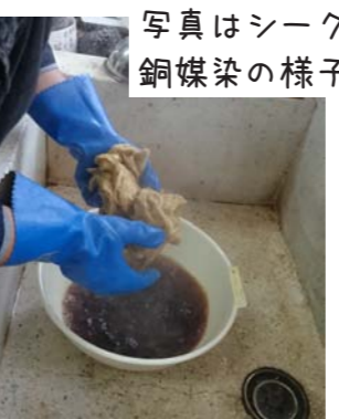
写真はシークワサー銅媒染の様子
