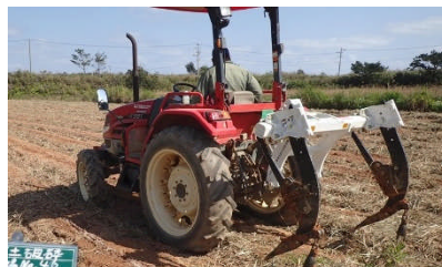
ハーフソイラで雨水の浸透性向上
