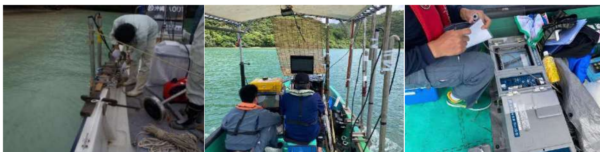
図Ⅱ-1-(2)-2 音響測深機及び音波探査機のセンサー取付と計測・記録風景
