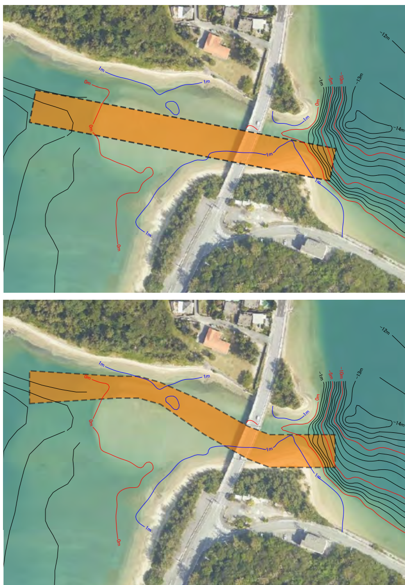
図 2.5.1-5 掘削レイアウト（上：案 1、下：案 2）
